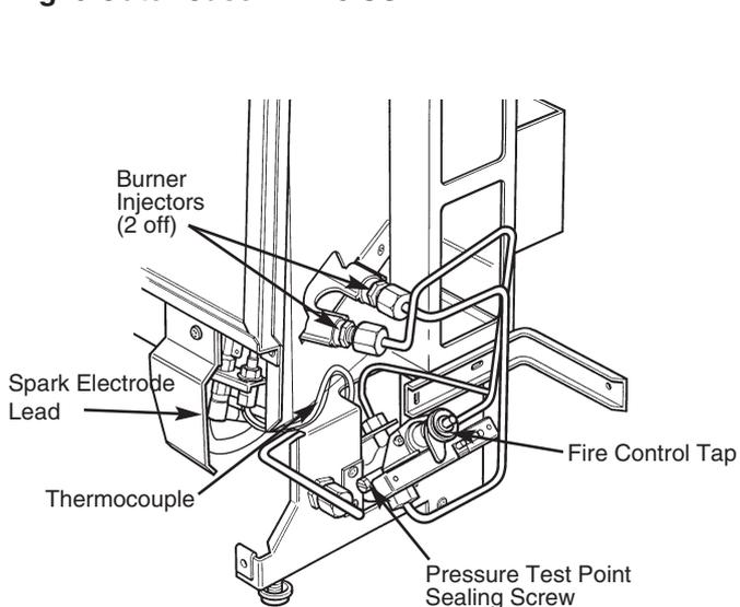
**Fig. 10 The Controls - GF3 SUPER**
