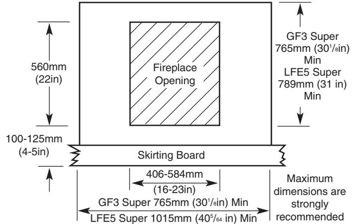
Fig. 2 Wall Fixing
