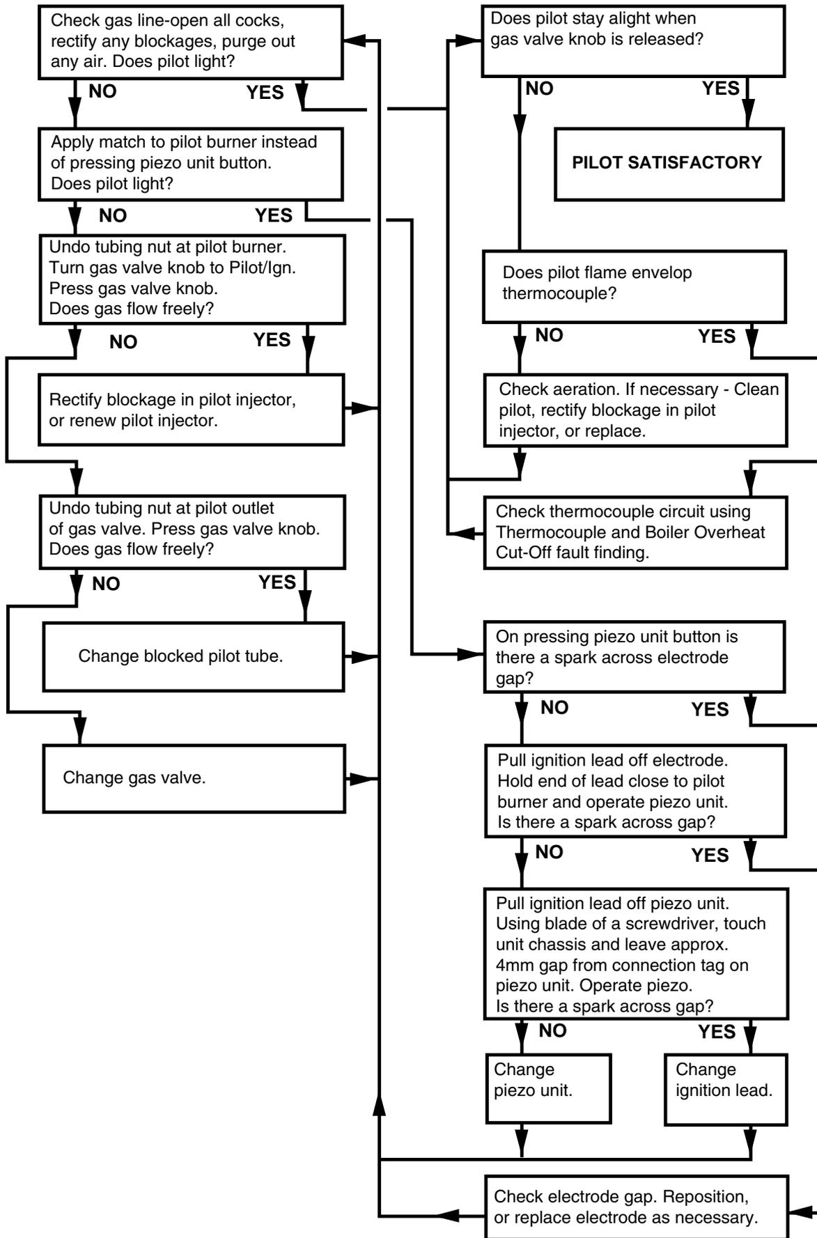
**BOILER PILOT FAULT FINDING**
