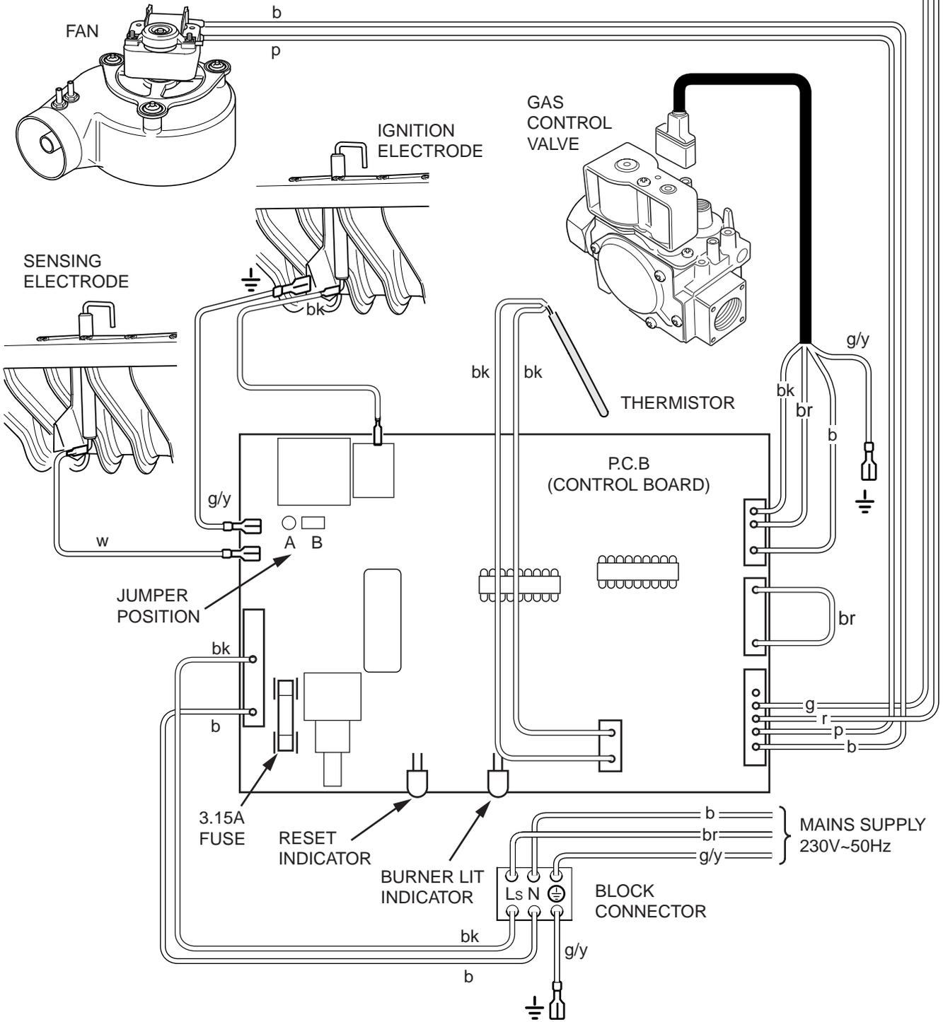
**BOILER PILOT FAULT FINDING**
