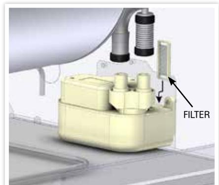
FIGURE 24. CONDENSE PUMP REMOVAL
