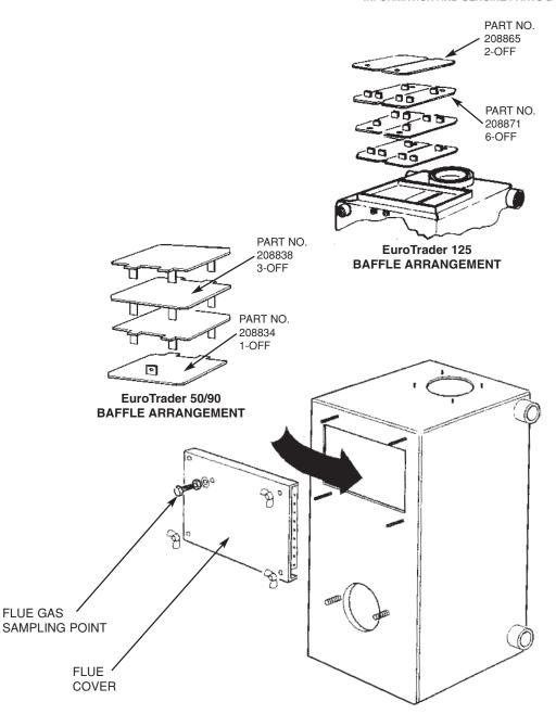
BAFFLES MUST BE FITTED IN THE ARRANGEMENT SHOWN i.e. GAP ALTERNATING FROM BACK TO FRONT
