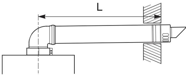
NOTE: THE FLUE MUST BE INCLINED TO THE BOILER
