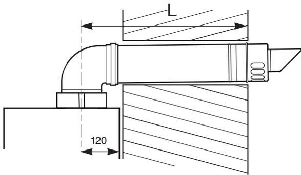
NOTE: THE FLUE MUST BE INCLINED TO THE BOILER
